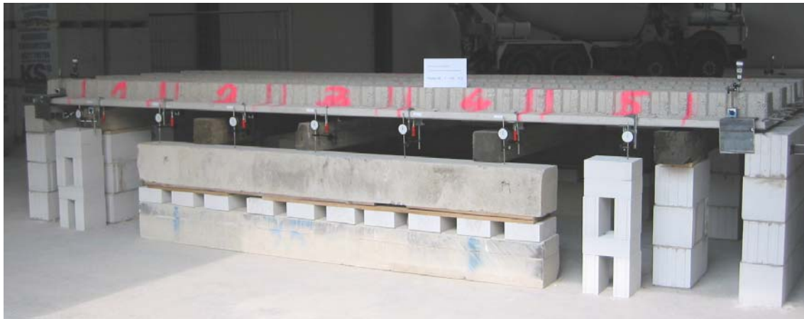
Bild 8.2: Anordnung der Abfangkonstruktion und der Messuhren
