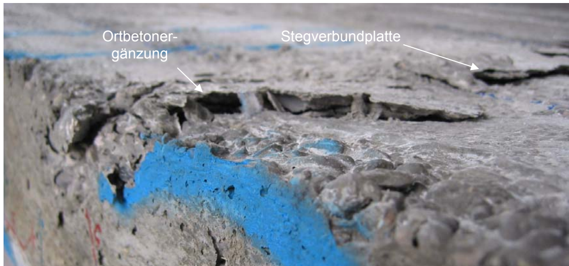
Bild 8.25: Versagen der Druckzone bei Stegverbundplatten mit Ortbetonergänzung
