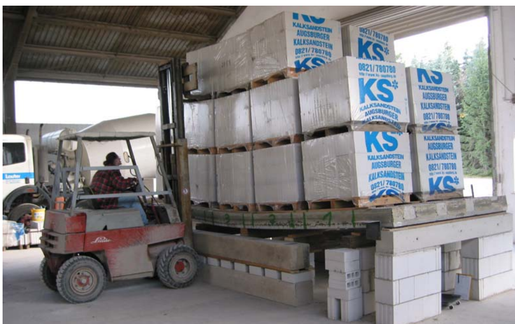
Bild 8.19: Belasten einer hochfesten Stegverbundplatte in der Nähe der Bruchlast
