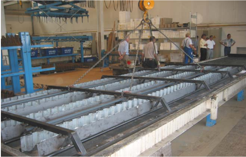
Bild 8.4: Schalungseinheit im fertigen Zustand
