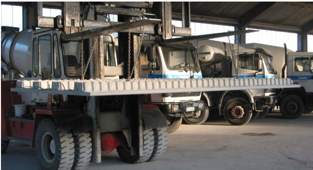
Bild 8.15: Transport einer Stegverbundplatte zur Versuchseinrichtung
