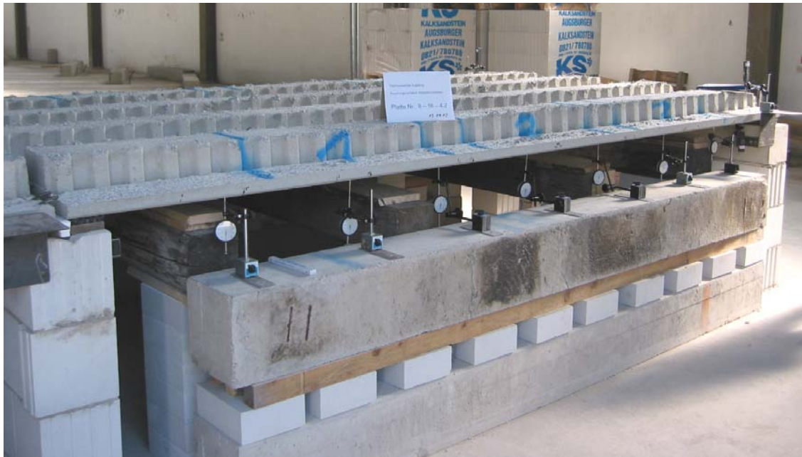
Bild 1.2: Stegverbundplatte auf Versuchseinrichtung
