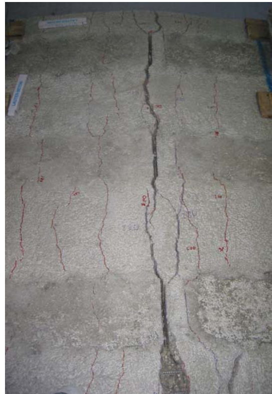
Bild 8.30: Rissbild bei der Bruchlast
