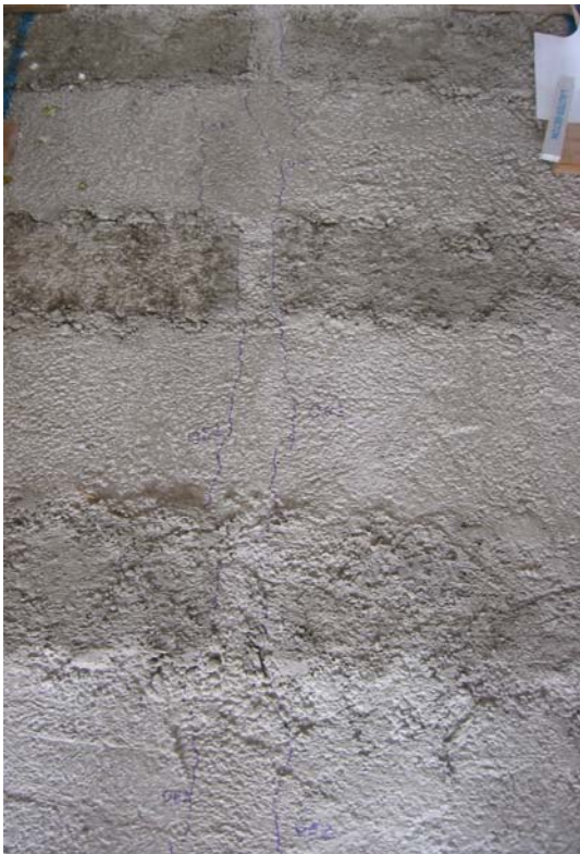
Bild 8.29: Rissbild bei ca. 65 % des Bruchmoments
