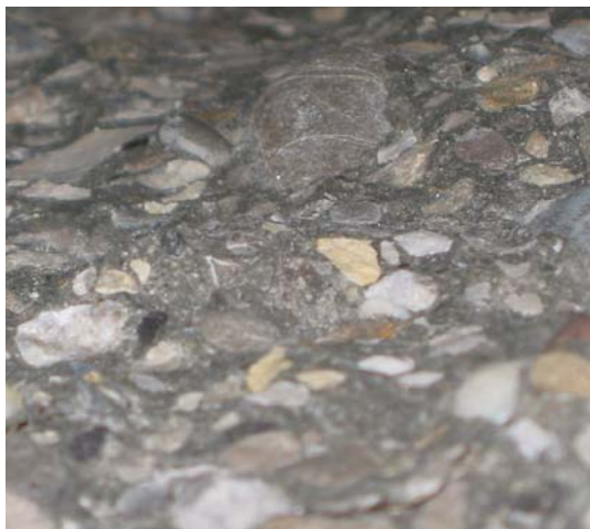
Bild 8.24: Gebrochene Zuschlagstoffe in der Bruchfläche einer hochfesten SVP
