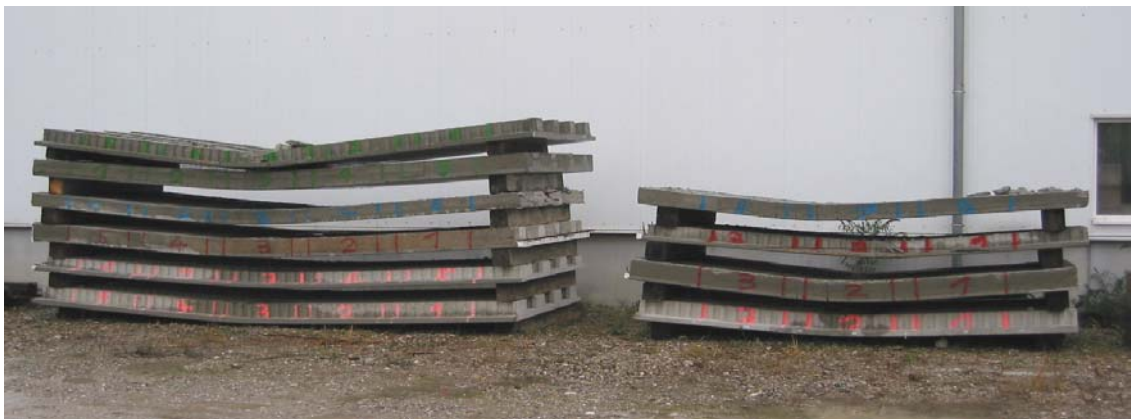
Bild 9.1: Stegverbundplatten nach der Belastung bis zum Bruchmoment
